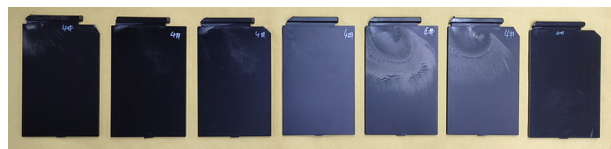
从左到右分别为配方A,B,C,D,E,F,G停留后第4模的样板状态,标记为A4,B4,C4,D4,E4,F4,G4
