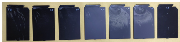
从左到右分别为配方A,B,C,D,E,F,G停留后第2模的样板状态,标记为A2,B2,C2,D2,E2,F2,G2
