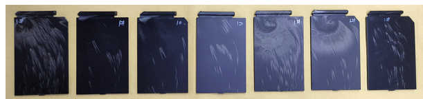
从左到右分别为配方A,B,C,D,E,F,G停留后第1模的样板状态,标记为A1,B1,C1,D1,E1,F1,G1
