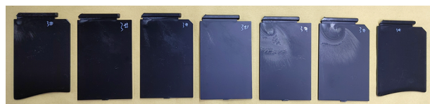
从左到右分别为配方A,B,C,D,E,F,G停留后第3模的样板状态,标记为A3,B3,C3,D3,E3,F3,G3
